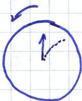
Der Massenpunkt bewegt sich im Inertialsystem geradlinig. Auf der rotierenden Scheibe ist die Bahn gekrümmt.  $\rightarrow$  Corioliseffekt.
