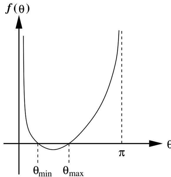
Winkel schwankt zwischen  $\vartheta_{\min}$  und  $\vartheta_{\max}$ : NUTATION der Figurenachse. Gleichzeitig umkreist die Figurenachse die  $x_3$ -Achse. Es ergibt sich folgender qualitativer Verlauf der Figurenachse auf der Einheitskugel:
