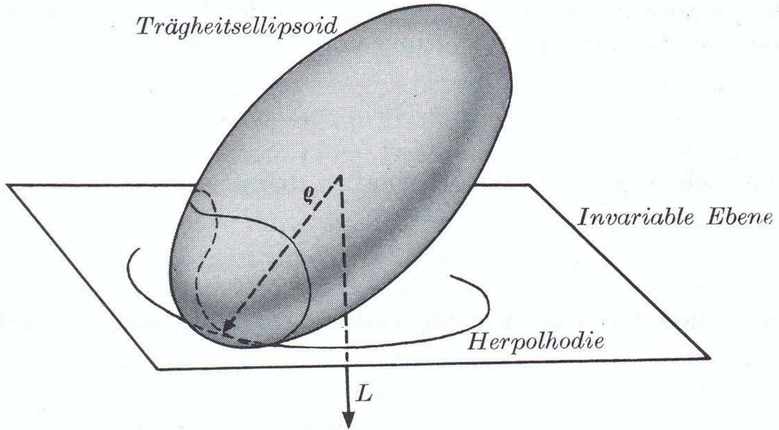
Die Figurenachse  $\vec{C} = \vec{d}$  und die momentane Drehachse  $\vec{\omega}$  des symmetrischen Kreisels beschreiben je einen Kreiskegel um die raumfeste Drehimpulsachse  $\vec{N}$ , und zwar mit konstanter Winkelgeschwindigkeit.  $\vec{C}$ ,  $\vec{N}$  und  $\vec{\omega}$  liegen stets in einer Ebene.  $\vec{C}$  und  $\vec{\omega}$  führen um  $\vec{N}$  eine reguläre Nutation aus. Der von  $\vec{C}$  um  $\vec{N}$  beschriebene Kegel wird Nutationskegel genannt.
