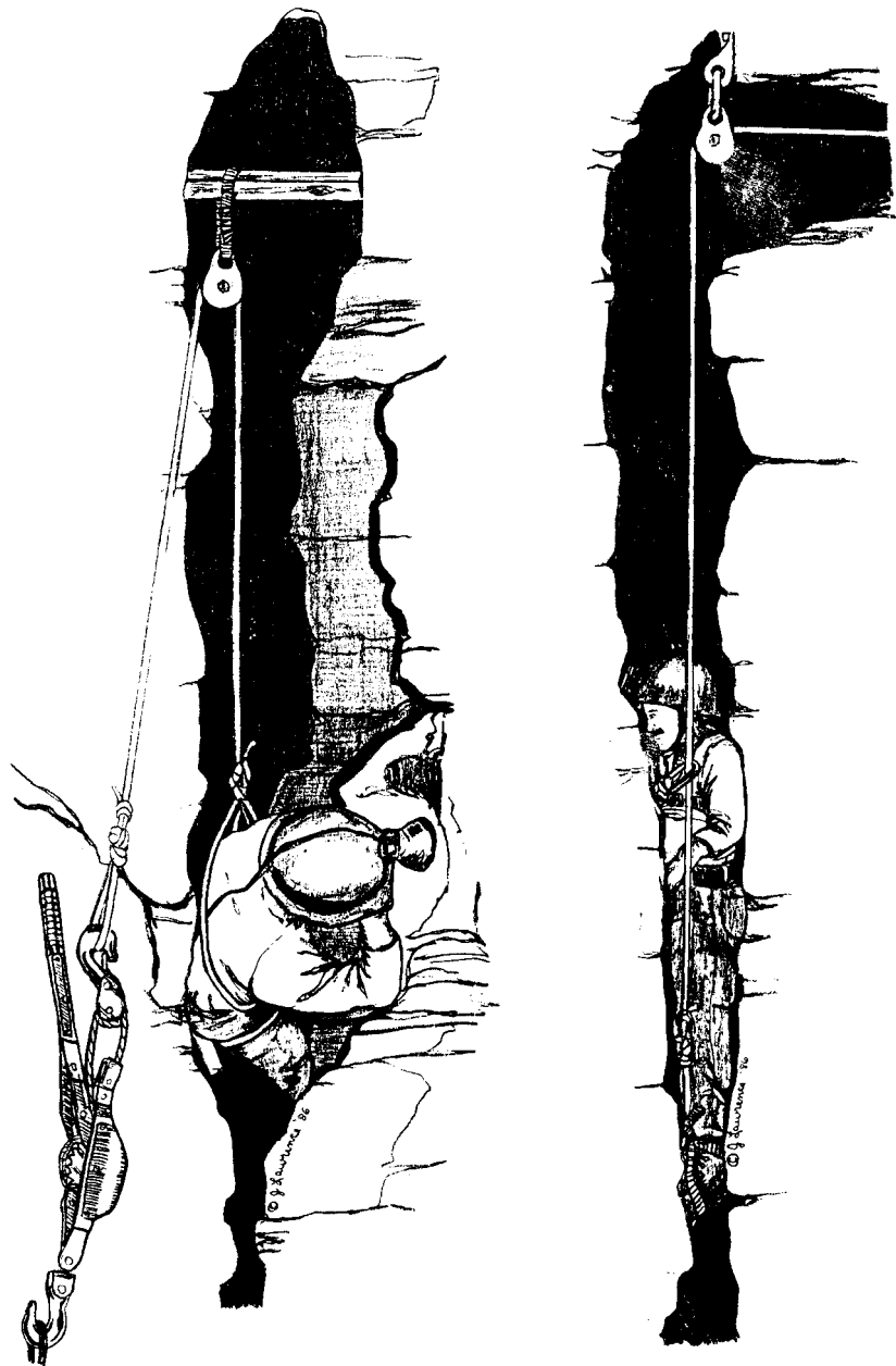
Mobiler Anker mittels Holzspreize (links), Verwendung von Fußschlinge (rechts) oder improvisiertem Brustgurt (links).
