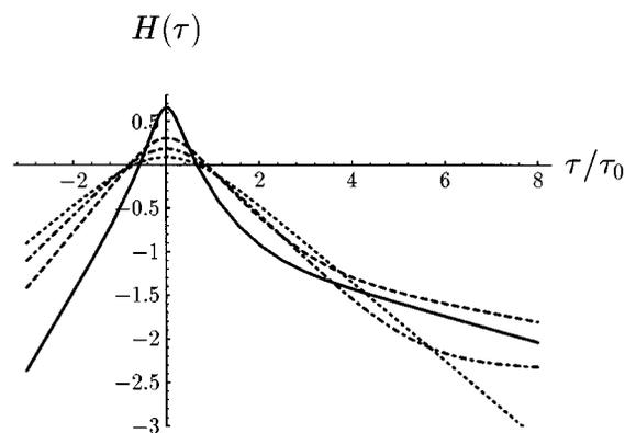
FIG. 4. Spectrum  $H(\tau)$  for  $G_m=9$ ,  $G_e=1$  and the fractional parameters  $q=0.8, \mu=0.65$  (—),  $q=0.6, \mu=0.5$  (- - -),  $q=0.52, \mu=0.515$  (- · - ·), and  $q=\mu=0.45$  (····).
